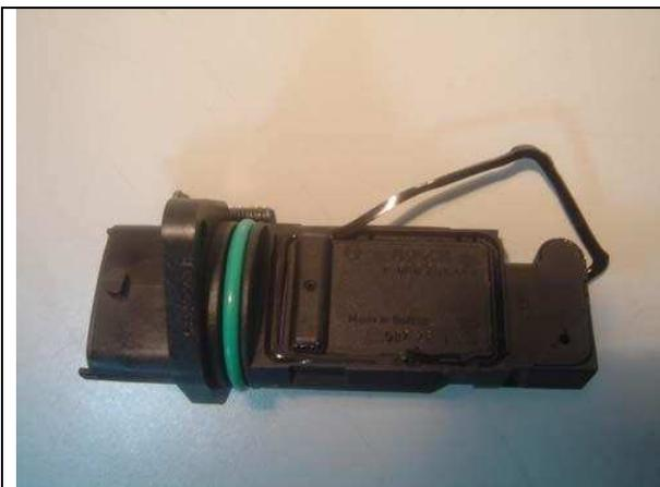
Крышка, закрывающая гибридную плату, имеет специальный резиновый герметик, не поддающийся разрушению на разрыв, он тянется
