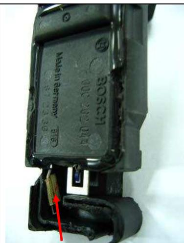
Рядом с датчиком припаян дополнительный терморезистор
