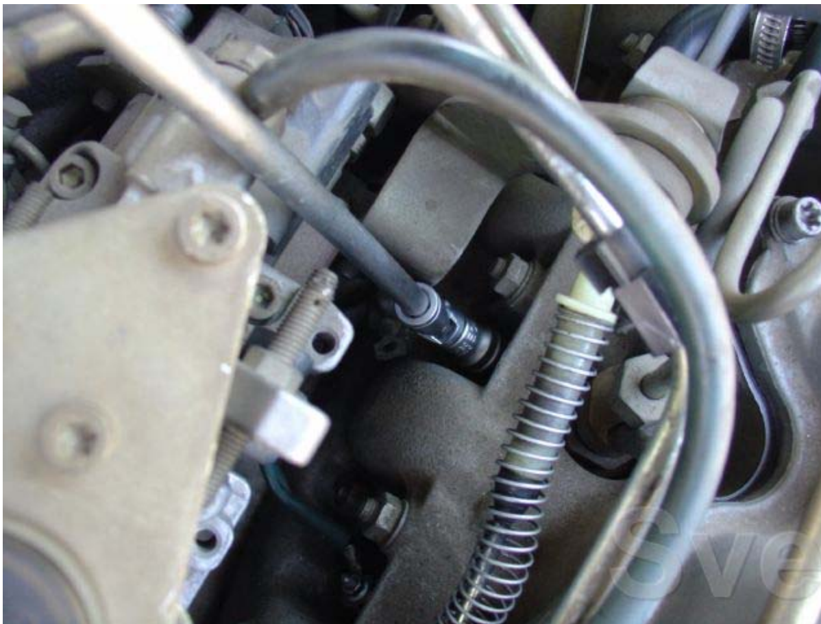
18. Подмяната на следващата свещ беше най-трудна. Самото място на което е разположена определя доста неудобен ъгъл на инструмента.
