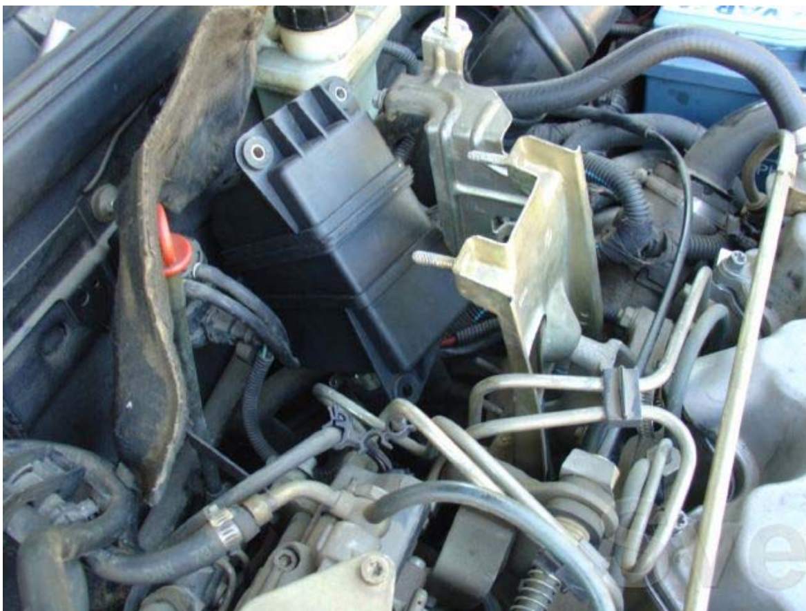
7. Единственото нещо, което се наложи да демонтирам е сепаратора. Гайките са за ключ 10мм. Не е кой знае какво, но има доста гайки за развиване на неприятни места. Достатъчно е да се махне само горния маркуч. Развиват се горните две гайки. След това долната гайка (от страната на помпата). За да има повече място се маха горивния филтър заедно с цялата конзола.
