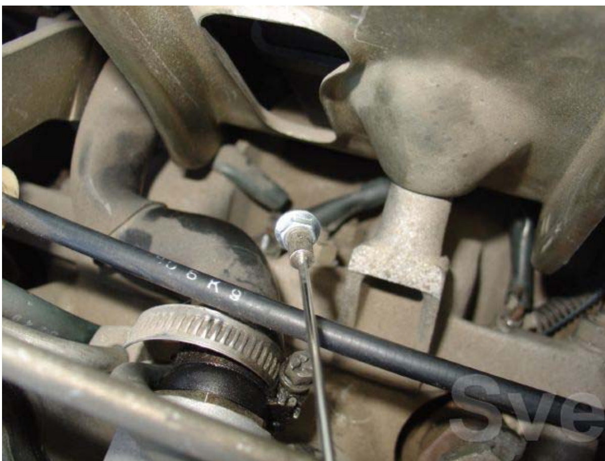
17. Тук е момента да спомена, че много удобен се оказа малък магнит с телескопична дръжка. С негова помощ поставях малките гайки.
